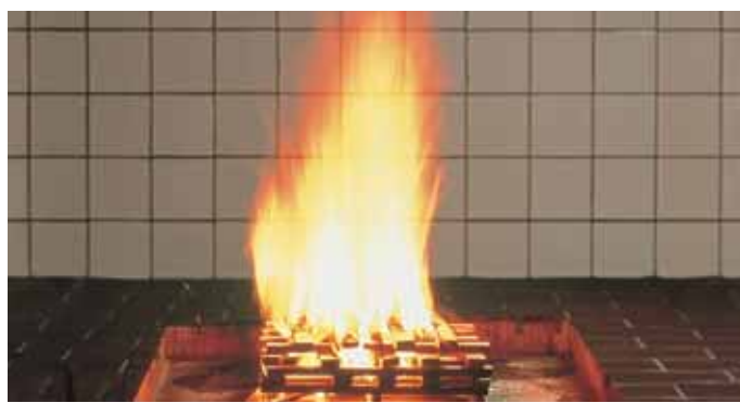
Testfeuer 1: offener Zellulosebrand (Holz)
